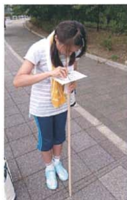
↑ 計測点に狙いを定め、方位盤で方位を測っている
