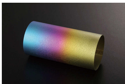
図4 陽極酸化で着色されたチタン合金
