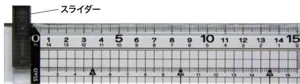
図6 ゼロピタ定規 左利き対応目盛りがあるので、左利きの児童も使える。裏面にセロハンテープを貼り、滑り止めにした。
